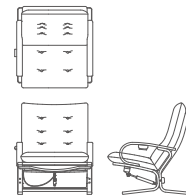
ワイドリクライニングチェア P04840B 【W835 D870~1070 H965~820 SH445 AH550】
